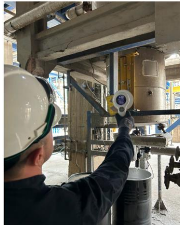
RaySafe 452 usado para medições de vazamento ao redor de medidores nucleares em uma refinaria.
